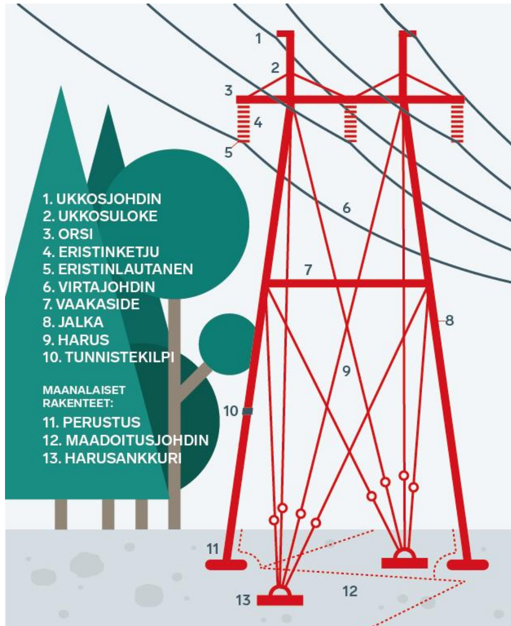
Kuva 6-4. Voimajohdon osat (Fingrid 2022).
